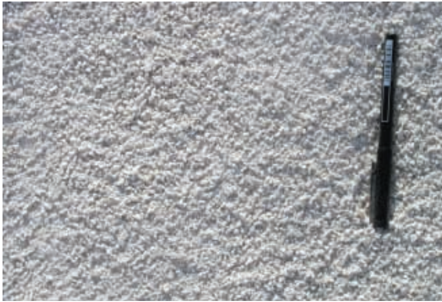
Figura 7.- Arenas de calidad obtenidas con las tres unidades automarchantes Triman en la cantera de Áridos Hermanos Guerrero, S.A.
