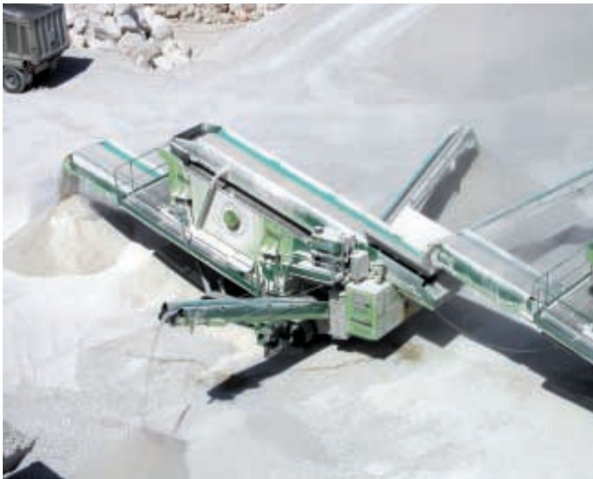
Figura 5.- El último equipo de cribado utilizado en la empresa Áridos Hermanos Guerrero es una Triman Track CVT-2045-III.
