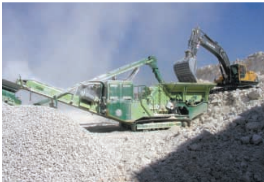
Figura 3.- Como unidad primaria se ha montado un Triman Track IMT-200
