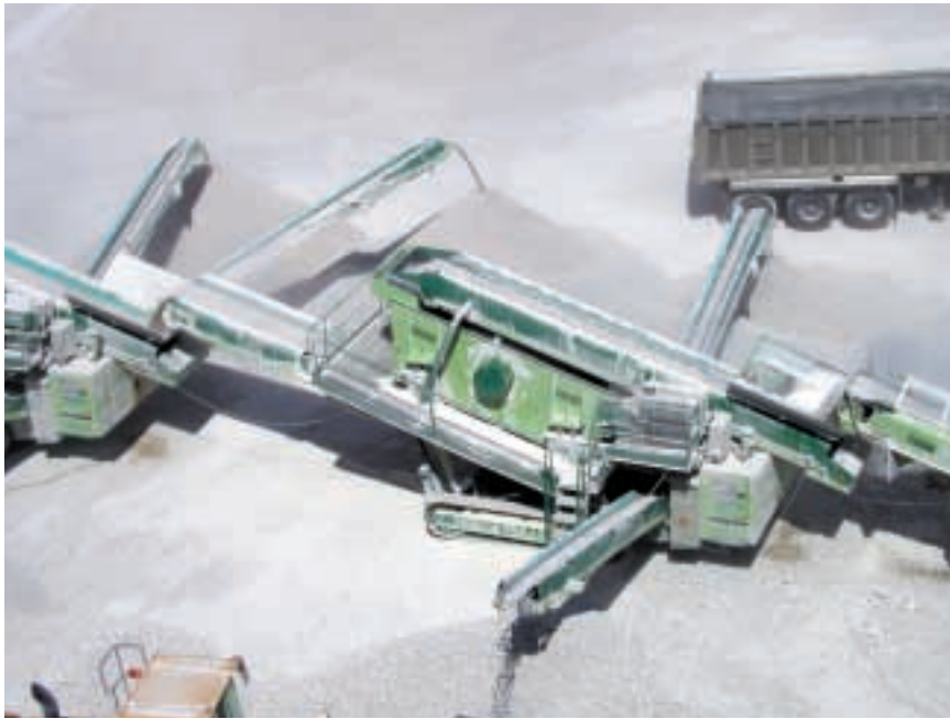
Figura 4.- La primera unidad de cribado es un Triman Track CVT-1540-III con criba de tres paños.
