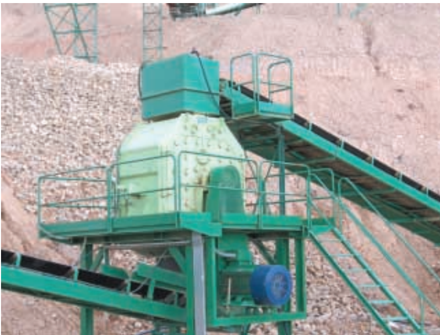
Figura 6.- El impactor Triman TMI-3 es el responsable de reducir la fracción 12-90 mm para los tamaños de salida 0-25 mm.
