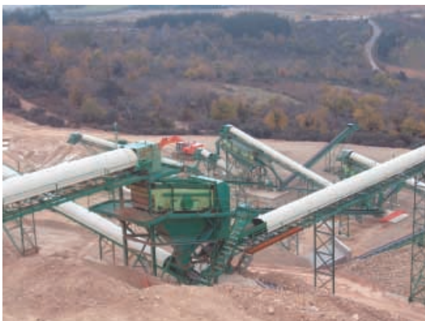
Figura 3.- La fracción 0-350 mm llega a una criba Triman CVT-1750 II para su primer corte.
