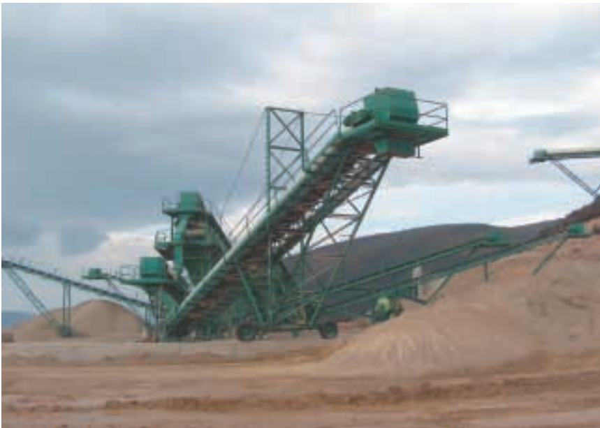
Figura 8.- La fracción 0-5 mm es acopiada directamente al suelo por un stacker de 24 metros de longitud.
