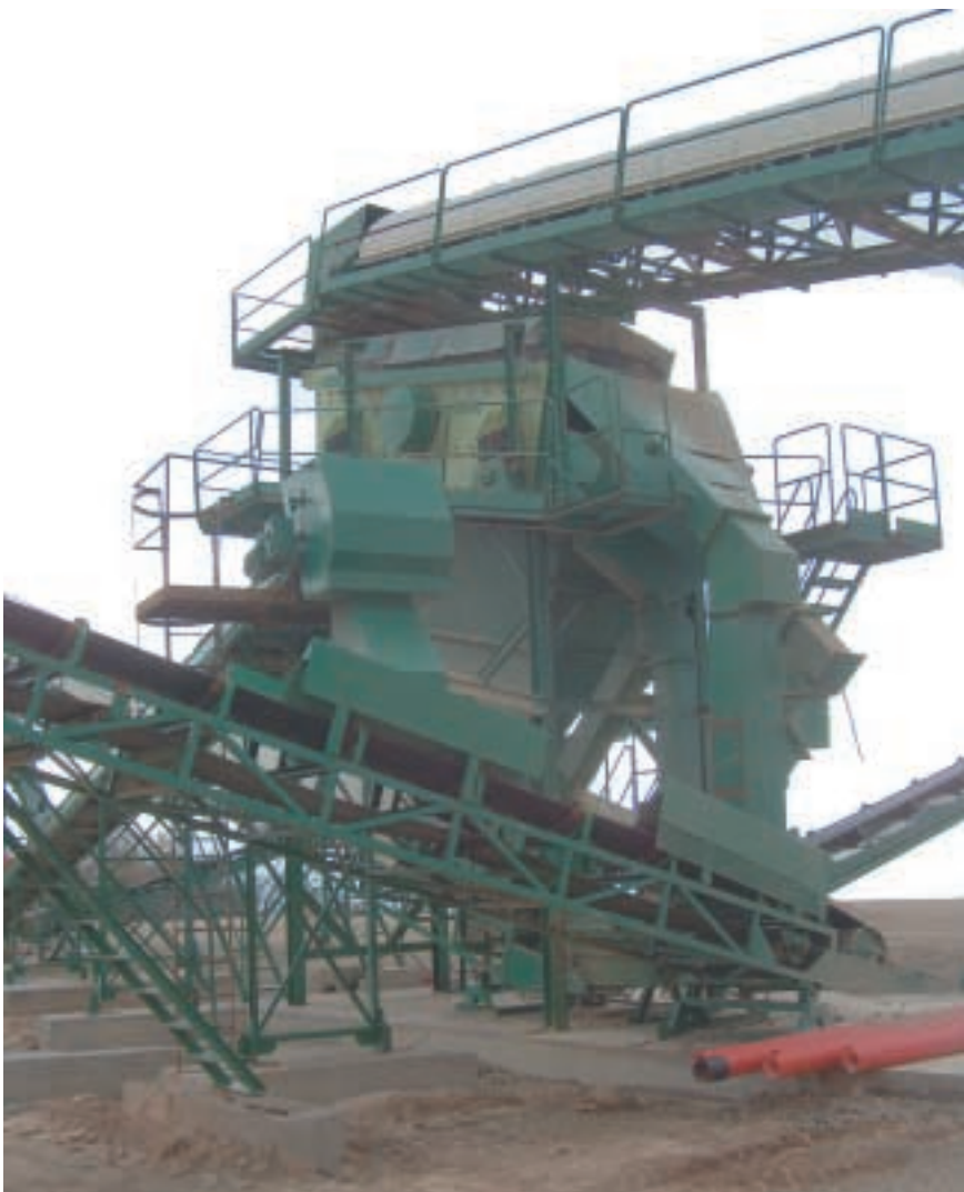
Figura 5.- En la segunda etapa de cribado la fracción 0-90 mm es cortada en cuatro granulometrías diferentes.
