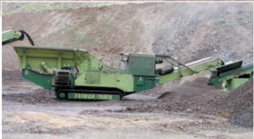
Figura 5.- Equipo móvil de Triman con molino impactor trabajando como unidad secundaria y alimentando a una criba móvil.
