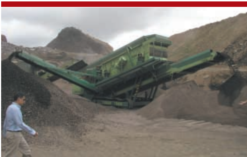
Figura 8.- La criba VCT-2045-III monta 3 paños para la obtención de 4 granulometrías diferentes.
