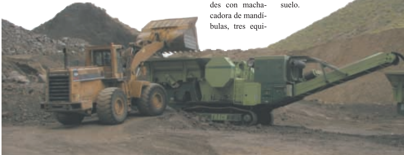
Figura 3.- El Trimán Track TMM-1300 con machacadora de mandíbulas siendo cargado por una cargadora de ruedas.
