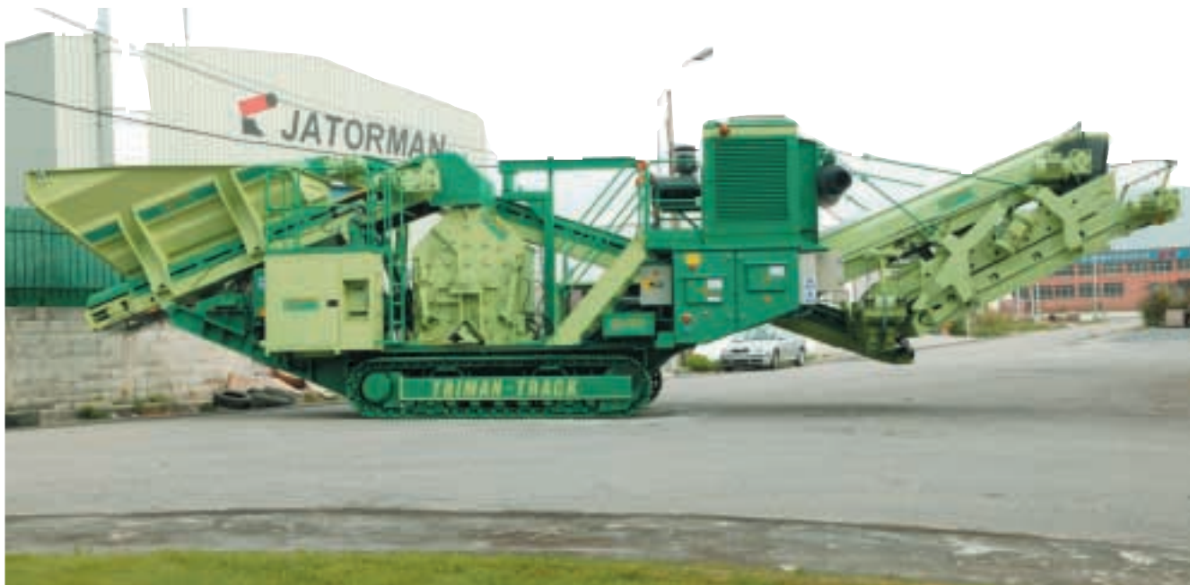
Figura 6.- Nuevo Triman-Track para la fabricación de arenas.
