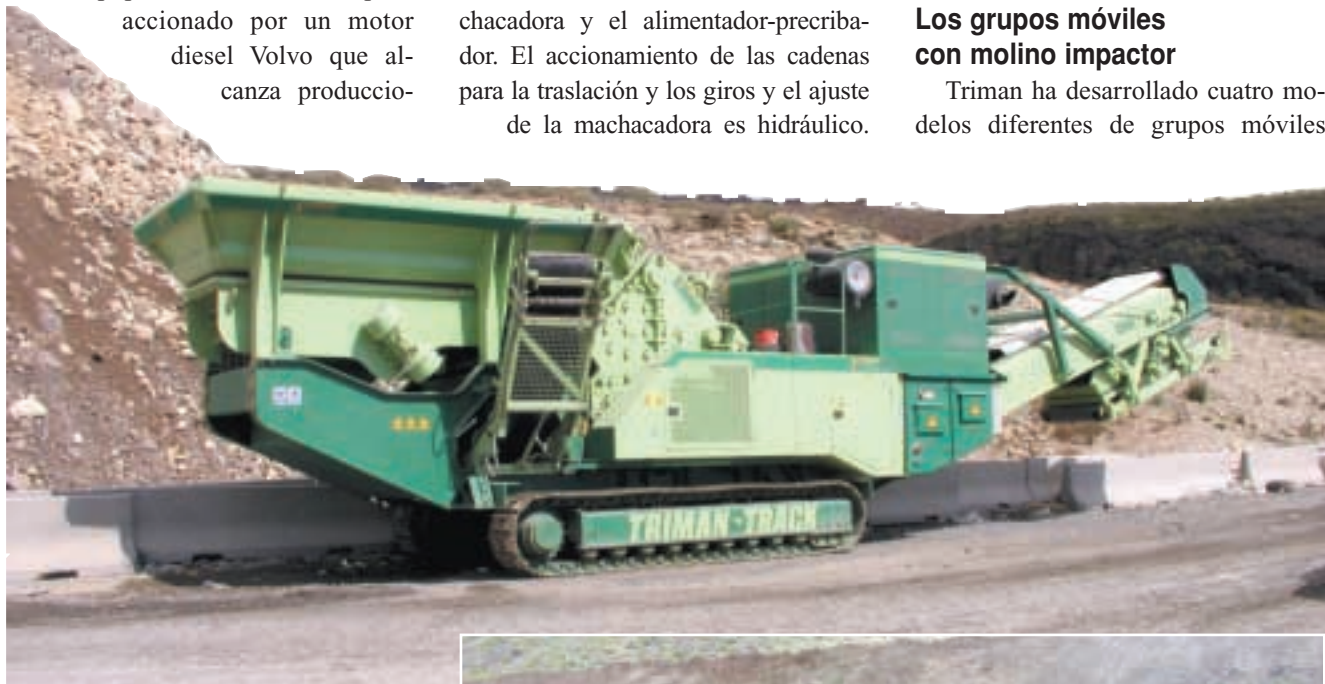
Figura 4.- Triman-Track con molino impactor. Obsérvese la posibilidad de montar criba en cabeza para separar el tamaño final en dos granulometrías diferentes.
