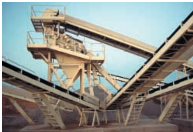
Figura 7.- Criba especial para arenas Triman CFT 1525 III.
