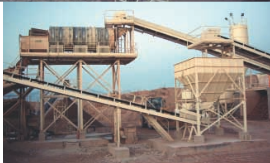
Figura 3.- Trómel de clasificación y lavado para la fracción 0-22 mm.
