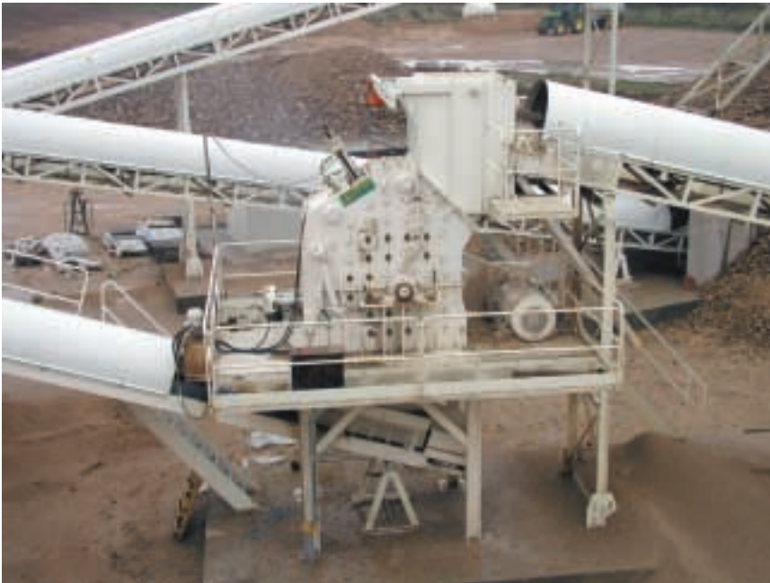
Figura 7.- Molino impactor secundario IST-4 de Triman montado para la reducción de la granulometría 22-80 mm.
