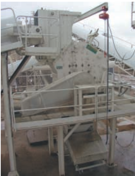
Figura 5.- Molino Triman IST-4 responsable de la reducción de la granulometría 40-300 mm.
