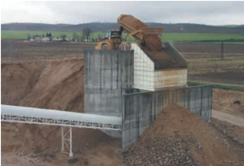
Figura 3.- Tolva de descarga. El material con tamaño > 300 es rechazado por la parrilla.
