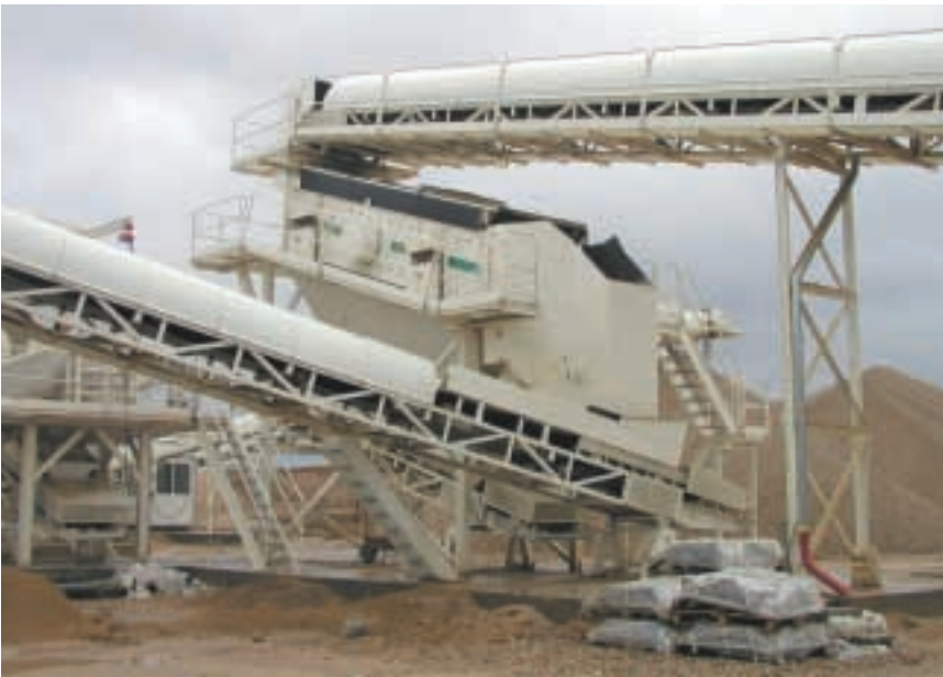
Figura 4.- En la etapa de preclasificación el todo-uno 0-300 mm es cortado en 0-40 y 40-300 mm.
